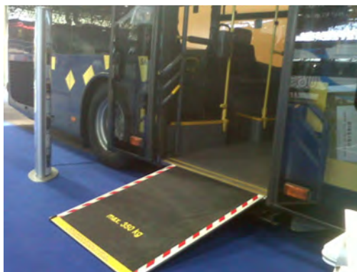
Imagen 6: Rampa de autobús
